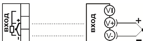
Рисунок 6 – Схема подключения термоэлектрического преобразователя
